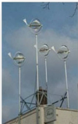
Eolienne de type Venturii
