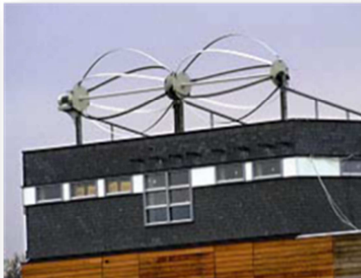
Eolienne de type Darrieus
