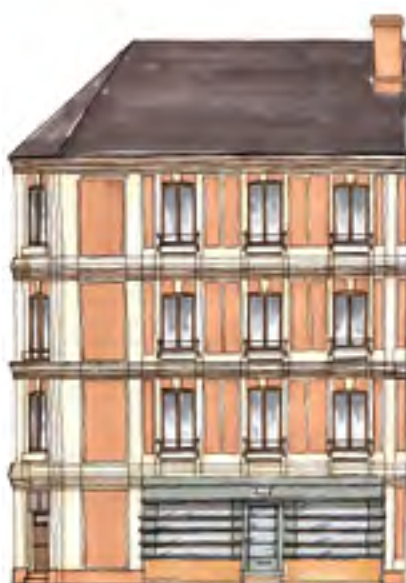
Transformation du commerce en logement en réalisant une façade contemporaine
