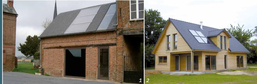
*Systèmes solaires intégrés à la toiture dans la continuité d'une ouverture en façade.
