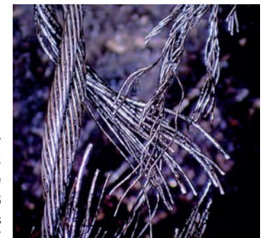
→ Brins de torons cassés essais de rupture 2015 DANS LES ARCHIVES DE JEAN-PIERRE LEROUX
