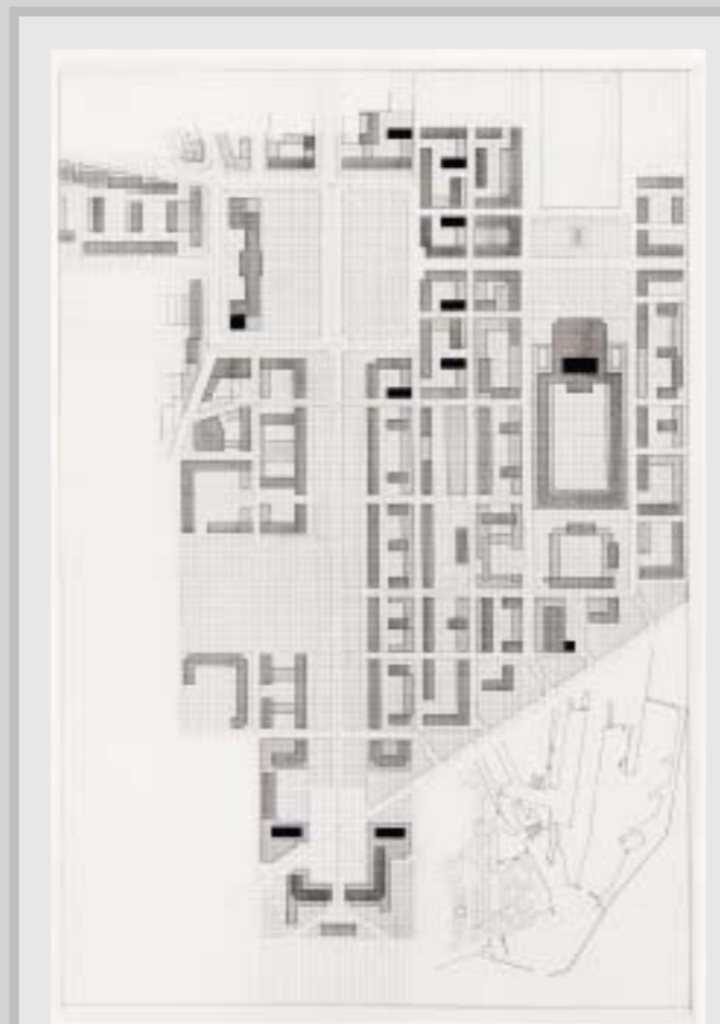
3-49. Atelier Perret : la trame constructive du Havre
